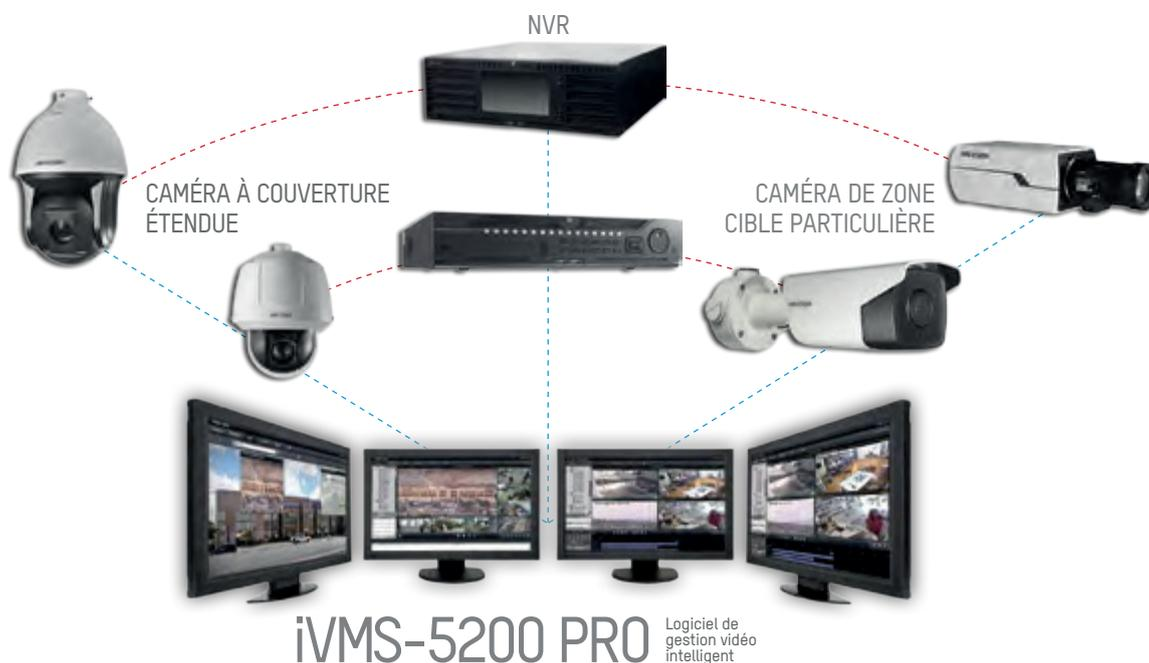
Le cœur d'un système de vidéosurveillance urbain est sa plateforme de commande et de contrôle : le système de gestion vidéo. Le logiciel iVMS-5200 Pro est la solution VMS de Hikvision pour une gestion simple et efficace de toutes les caméras vidéo en cours d'utilisation (caméras de zone cible spécifique, à couverture étendue ou de lecture de plaques minéralogiques).
