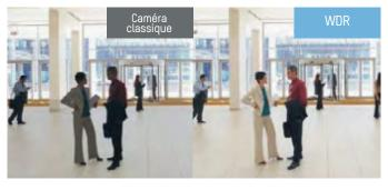
et une précision des couleurs inaltérée, ces caméras produisent d'excellents résultats dans des conditions d'éclairage qu'aucune caméra classique ne peut traiter.
